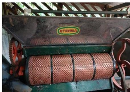
Figura 10. Máquina despulpadora marca Eterna para el proceso de despulpado del grano
