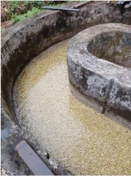
Figura 13. Proceso de lavado del grano en el canal de correteo de concreto
