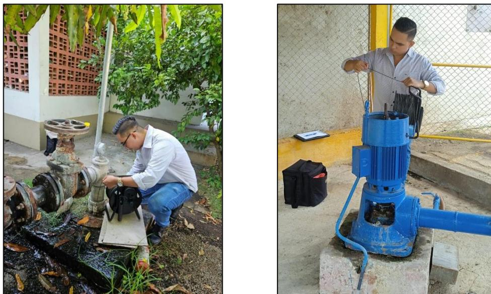
*Figura 10.* Medición del nivel estático del agua subterránea
