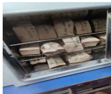
Muestras ingresadas en horno a 60 °C para la extracción de humedad
