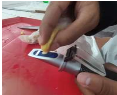
Aplicación de 2 gotas de sustratos de maíz en el refractómetro
