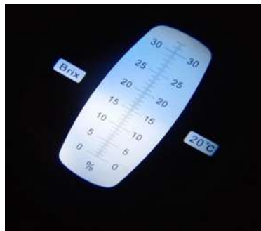
Lectura de grados Brix en refractómetro
