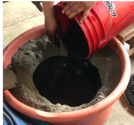
Anexo 4. Mezcla de harina de semilla de Jícara con Melaza para la elaboración de los bloques.
