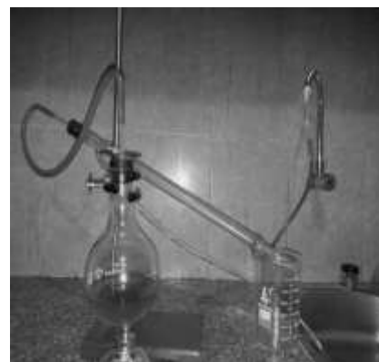
Figura 13. Sistema de destilación.
