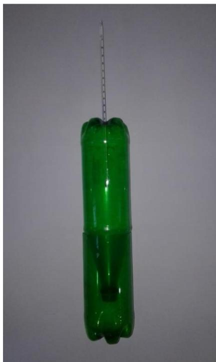
Figura 7. Unidad experimental Ashbell para realizar prueba de estabilidad aeróbica
