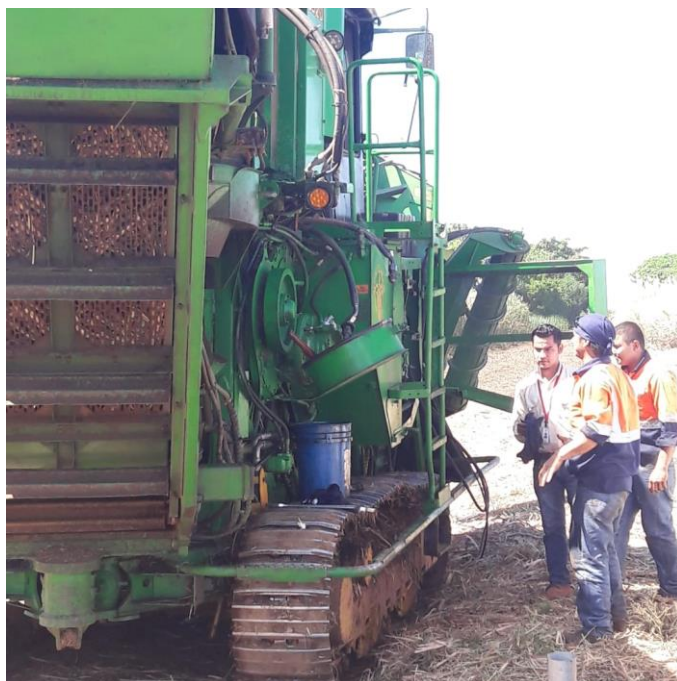
Anexo 5. Cosechadora John Deere de código 77004. Se le realiza cambio de aceite hidráulico
