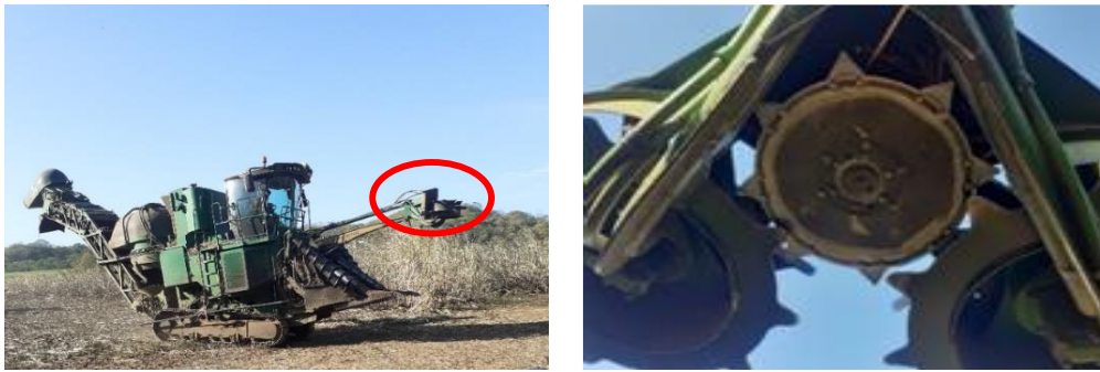
Figura 4. Vistas verticales y de fondo del despuntador
