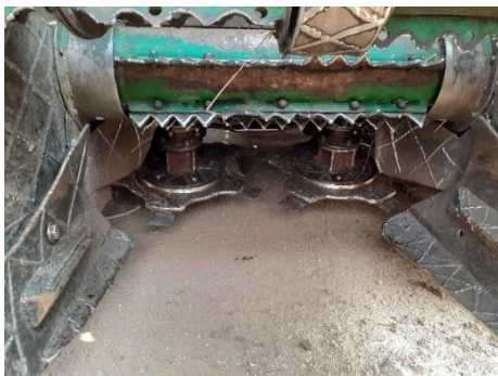
Figura 7. Movimiento de corte de las cuchillas base.
