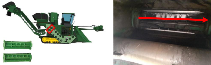
Figura 10. Ubicación de las cuchillas picadoras y sentido de filo.
