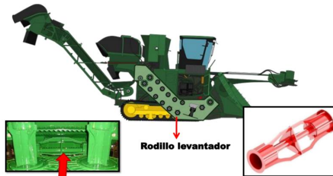
Figura 8. Posición del rodillo en la cosechadora.
