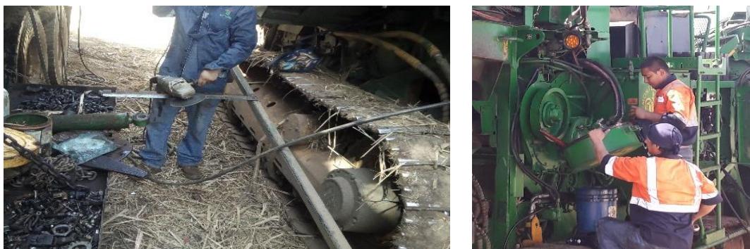
Figura 18. Mantenimiento General de la cosechadora cosechadora marca John Deere de código 77002, modelo 3520, esmerilado de cuchilla picadora y reparación de manguera hidráulica
