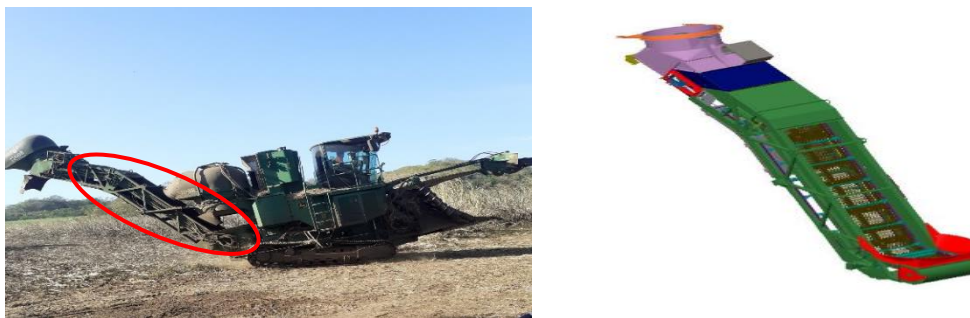
Figura 12. Sistema de Elevador
