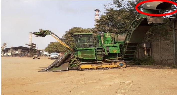
Figura 13. Extractor de Cosechadora con el código 77002 marca John Deere modelo 3520
