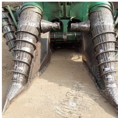
Figura 5. Vista vertical de los divisores.
