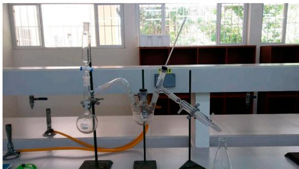
*Montaje de destilación para la obtención de aceites esenciales.*
