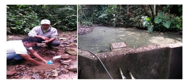
Figura 10. Medición de caudal y área de captación e infraestructura de la fuente que abastece la comunidad Caratera, municipio El Tuma-La Dalia.
