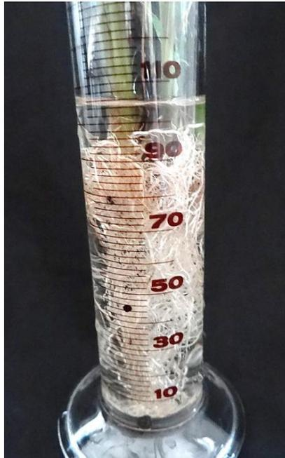
**Figura 2.** Determinación del volumen de raíces del cultivar de caña de azúcar CC-06791.
