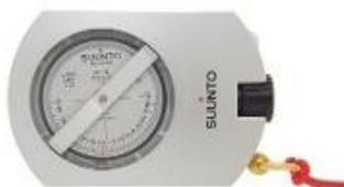
**Figura 4.** Clinómetro Suunto para medir pendiente y altura
