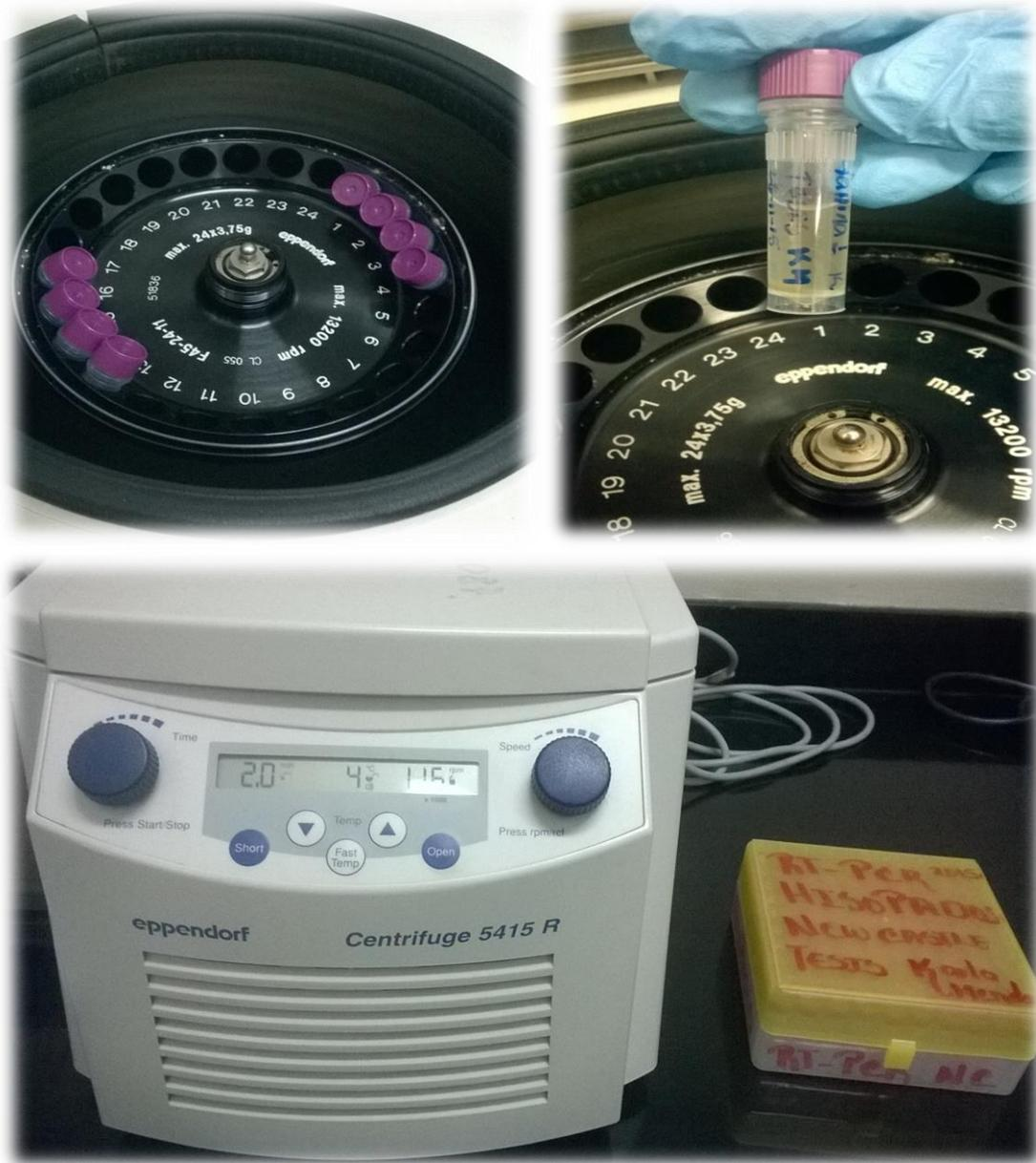
**Fotografía 4. Centrifuga5415R utilizada en área de extracción. Fuente: Mendoza 2015.**
