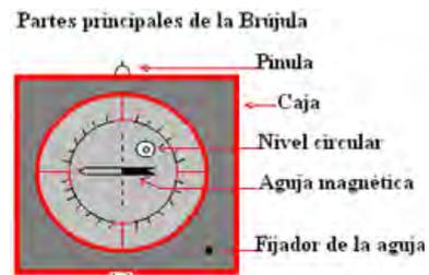
**Aguja magnética:** aguja imantada la cual debe girar libremente sobre un pivote colocado al centro del círculo graduado.
