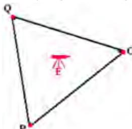
b) Se planta y nivela el instrumento en un punto E, desde donde sean visibles todos los vértices de la poligonal.
