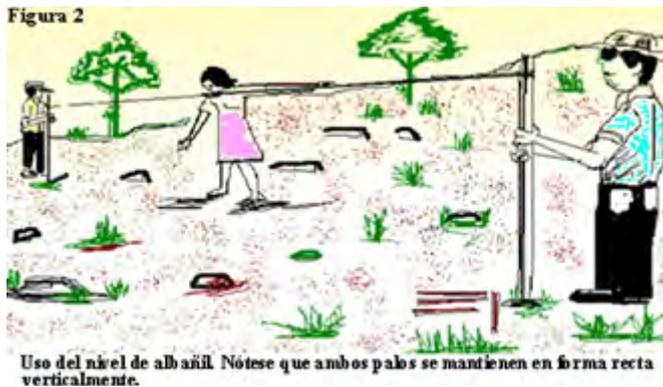
De esta forma se obtiene una curva a nivel con marcas de cada 10m. El método también sirve para determinar el % de pendiente de un terreno, en este caso hasta el 15% de inclinación, lo cual se logra moviendo la cuerda a lo largo del palo interior hasta que el nivel marque cero inclinación, tomando la lectura de forma tal que cada tramo de 10cm que se ha bajado la cuerda indica un desnivel de 1%.
