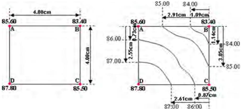
Cabe señalar, que para el trazado de las curvas de nivel en el plano, siempre se debe de tener presente la configuración del terreno, observada durante el levantamiento de campo.
