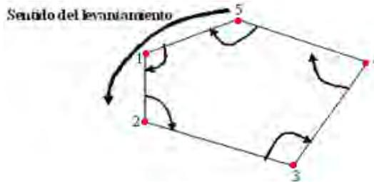
**Ángulos Externos en una Poligonal Cerrada.** Los ángulos externos en una poligonal cerrada van a depender del sentido del levantamiento y estos pueden ser Derechos o Izquierdos:
