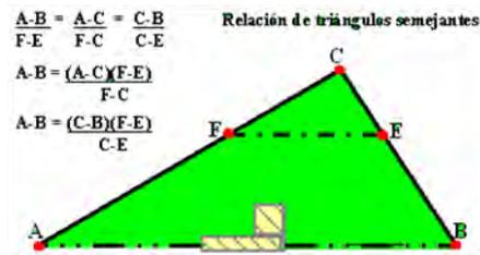
**Cuarto.** Se ubica el punto **E** el cual debe estar a una distancia de **C** de  $\frac{1}{2}$  ó  $\frac{1}{3}$  de la distancia medida **C-B**, y así aplicamos la relación de triángulos semejantes y podremos calcular la distancia **A-B**.
