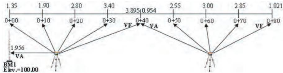
Paso2. Calcular las elevaciones del perfil que es la línea central por donde vamos a excavar la zanja.
