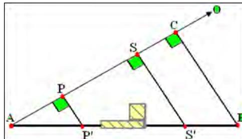
**Segundo.** Se levanta una perpendicular sobre la línea **A-O** en el punto **C** y que pase por el punto **B**.
