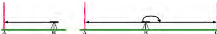
**Método 3:** este método, se conoce con el nombre de doble punto y se emplea cuando se desea prolongar una línea con mucha precisión, apoyándonos en la figura anterior se sigue el siguiente procedimiento:
