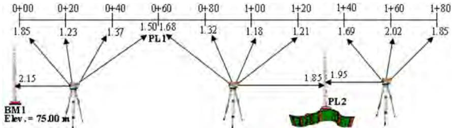
7. Calcular las elevaciones de la rasante para la construcción de un canal con una pendiente de 0.5% (-) y una longitud de 200 metros con estaciones cada 20 metros, la rasante debe pasar por la subestación 0+105 a una elevación de 55.45m
