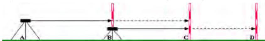
**Método 2:** se coloca el teodolito en **B** y se da vista en **A**. Luego con el movimiento general vertical, se invierte el telescopio (vuelta de campana) y se fija el punto **C**.
