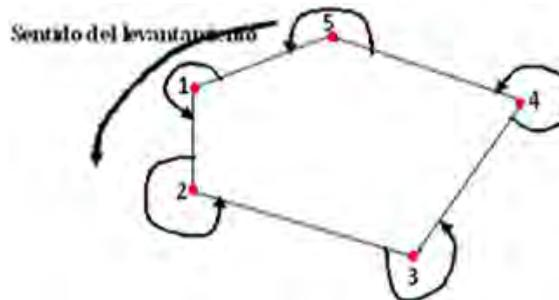
Hay que hacer notar, que para girar un ángulo en un determinado vértice de la poligonal, sea abierta o cerrada, se deberá visar (observar) el vértice anterior y girar el ángulo en su sentido correspondiente hacia el siguiente vértice, según sea el sentido del levantamiento.
