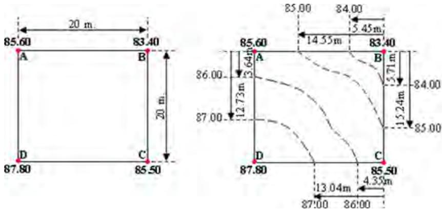
Para representar estas curvas de nivel en un plano, se procede a aplicar la escala a la cual serán dibujadas las curvas de nivel, en nuestro caso utilizaremos una de 1:500 y se realizan las respectivas transformaciones de distancias en el terreno con sus respectivas distancias en el plano como las mostradas en la tabla siguiente:
