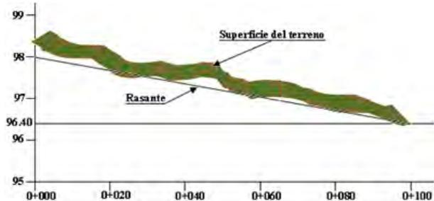
Ejemplo 2 (Conocida una elevación de partida y la pendiente). Calcular las elevaciones de la Rasante en cada estación, si la pendiente de la rasante es de 2% (+). La Rasante parte de la estación 0+00 y termina en la 0+60 con estaciones cada 10m., y tiene que pasar con una elevación de 56.50m en la subestación 0+36.50.
