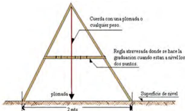
2. Nivel de Caballete: el caballete consiste en una vara horizontal sostenida en sus extremos por dos patas de igual altura y un nivel colocado en la parte media de la vara horizontal. Para ampliar los usos del caballete se acostumbra construirlo con una de sus patas extensibles, de manera que se puedan trazar líneas con un desnivel o pendiente dada. La vara horizontal por lo general se le da 2 metros de longitud, para efectos del cálculo de la longitud que se debe alargar la pata extensible
