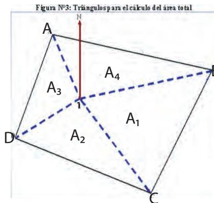
En la figura N°3 se observa que, se nos han formado cuatro triángulos  $\Delta(B1C)$ ,  $\Delta(C1D)$ ,  $\Delta(D1A)$  y  $\Delta(A1B)$  a los que se les procede a calcular su área respectiva.
