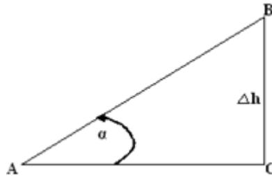
Cuando se mide el ángulo vertical y la distancia inclinada, el desnivel se obtiene de la siguiente manera:
