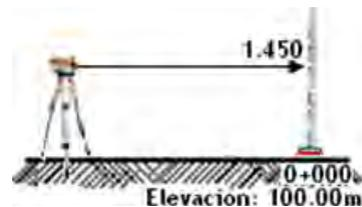
3). Efectuar una lectura de VA con el objetivo de determinar la altura del instrumento, para nuestro ejemplo la lectura de VA sobre la estación 0+000 es de 1.450m por lo tanto la altura del instrumento será de 101.450m.
