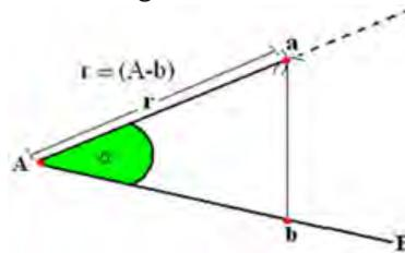
**4.-Alineación entre puntos no visibles por obstáculos:** el alineamiento entre dos puntos visible el uno del otro no presenta gran problema, ya que este se puede solucionar poniendo puntos intermedios con jalones llamados auxiliares. El problema se presenta cuando se trata de determinar el alineamiento entre dos puntos no visibles el uno del otro por algún obstáculo. Para esto vamos a ver un ejemplo representado en el siguiente dibujo:
