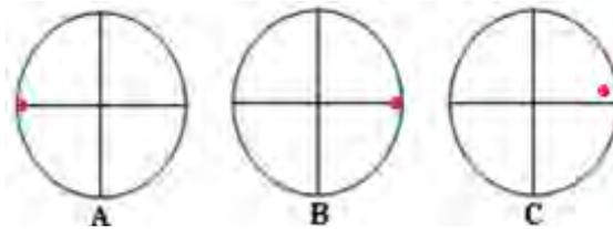
En la figura A, aparece el punto sobre el hilo horizontal en un extremo, en la figura B, aparece el punto luego de haberlo girado siempre sobre el hilo horizontal, lo que demuestra que el instrumento está correcto. La figura C, nos representa al punto sobre el hilo horizontal o sea que el punto y el hilo no coinciden en el otro extremo, lo que nos demuestra que el hilo horizontal del retículo no es horizontal.
