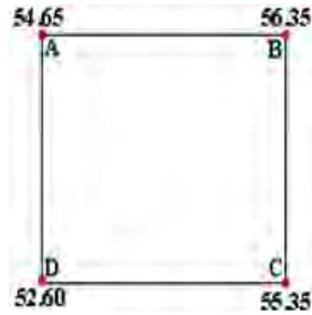
Las curvas de nivel que pasan entre el vértice A y el B son las curvas de nivel con elevación 55.00m, 55.50m y 56.00m. Las que pasarán entre el vértice B y el C son las 55.50m y 56.00m. Las que pasarán entre el vértice C y el D serán las 53.00m, 53.50m, 54.00m, 54.50m y la 55.00m y las curvas que pasarán entre el vértice D y el A serán la 53.00m, 53.50m, 54.00m y la 54.50m.
