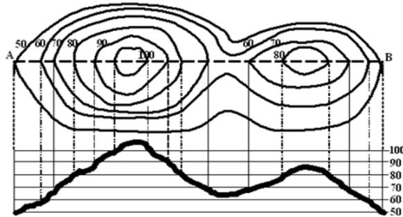
Como podemos observar en el gráfico, el perfil se dibuja en la escala de referencia de las elevaciones, que para este caso se utilizó una escala de 50 a 100 que son la menor y mayor elevaciones que tienen el plano de las curvas de nivel; en los puntos donde se intersectan las curvas con la recta A-B, se bajan perpendiculares a la escala de referencia, ubicando cada punto con su respectiva elevación, para luego unir a mano alzada todos los puntos y de esta forma obtener el perfil.
