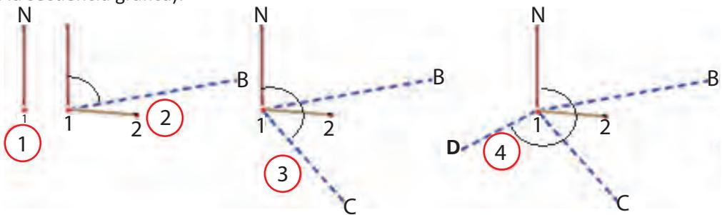
Posteriormente se miden y trazan los ángulos derechos tomando como referencia la línea base 1-2 considerando el  $0^{\circ} 0'$  en el punto 1 y teniendo como centro de giro el punto 2 (pasos del 6 al 9 en la secuencia gráfica siguiente), se observará que las líneas utilizadas para indicar los azimut y los ángulos derechos se intersectan justo en los vértices de la poligonal, por lo que de esta manera queda definida la posición de cada uno de estos vértices en el plano.
