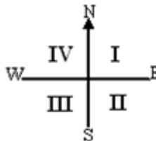
Para calcular el rumbo de cualquier línea a partir del azimut, vamos a enumerar los cuadrantes de la siguiente manera:
