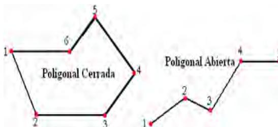
**Ángulos Internos en una Poligonal Cerrada.** Los ángulos internos en una poligonal cerrada van a depender del sentido en que se levante la poligonal y estos pueden ser Derechos o Izquierdos:
