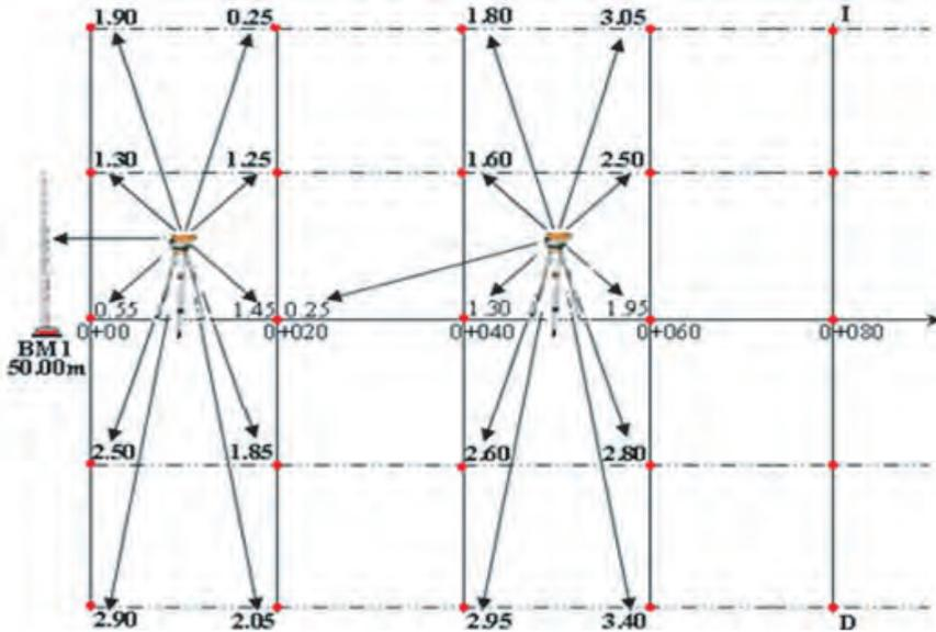
Modelo de cartera para el registro de datos en secciones transversales
