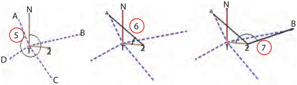
Ahora unimos estos vértices con trazos rectos, para que quede dibujada nuestra poligonal (paso 10). Finalmente borramos todas las líneas que no correspondan al perímetro de la poligonal y agregamos los detalles finales para confeccionar el plano definitivo, según como se observa en la siguiente secuencia gráfica (paso 11):
