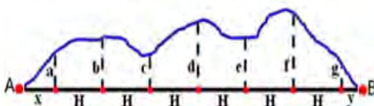
Como se puede observar en los extremos del lindero irregular se forman triángulos rectángulos cuyas áreas se determinan aplicando la fórmula de un triángulo rectángulo y entre la ordenada  $a$  y  $g$ , se observa que se forma una sucesión de trapecios, por lo que el cálculo del área de dicha sección, se realiza aplicando la fórmula respectiva como se explica más adelante.
