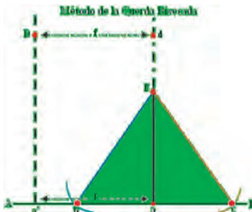
**D** = punto por donde debe pasar la perpendicular levantada en la recta **A-B**.
