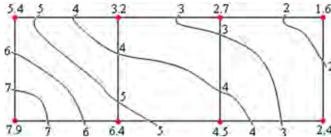
En el ejemplo podemos notar, que la menor elevación de un vértice de la cuadrícula es 1.6m y la mayor 7.9m, por lo tanto, si el intervalo vertical es de 1m., las curvas de nivel que se tienen que dibujar son las que tienen elevación 2, 3, 4, 5, 6 y 7m, ubicando la distancia horizontal entre cada cuadrícula, de una manera aproximada.
