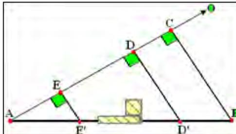
Se pide calcular las distancias **D-D'** y **E-E'**, para luego levantar perpendiculares en los puntos **D** y **E**, y así poder ubicar los puntos **D'** y **E'** que permitan el alineamiento entre **A** y **B**.
