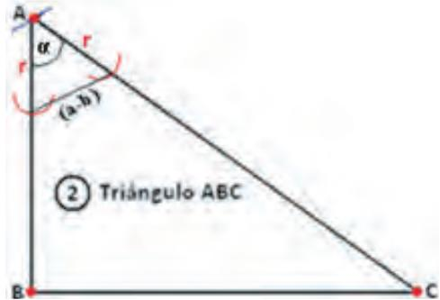
Para calcular el área se aplicará la fórmula  $A = \frac{1}{2} a b \text{sen} \alpha$  según nuestros datos esto es  $A_T (ABC) = \frac{1}{2} (A - B) (A - C) \text{sen} \alpha$ , para ello se debe de determinar primero el ángulo en A, utilizando el radio y la cuerda medida, en la fórmula  $\alpha = 2 \arcsen \left[ \frac{(ab)}{2r} \right]$ , sustituyendo los datos
