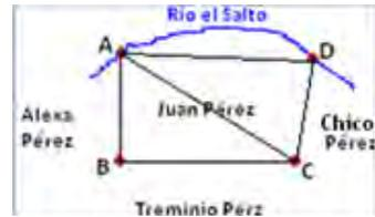
Al analizar el perímetro del área, se establece que ésta se debe de dividir en una sección irregular definida por la recta A-B y la margen del Río, y dos triángulos; el triángulo ABC y el triángulo ADC, para poder realizar el levantamiento de los datos de campo, como se muestra en la siguiente secuencia gráfica (1, 2 y 3):
