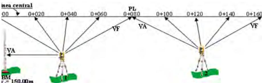
Para este caso de nivelación del perfil, se utiliza una estación de la línea central como punto de liga (o punto de cambio), por lo tanto la lectura en la estación 0+80 se tiene que anotar como VF estando el instrumento en la posición 1, luego se cambia el nivel y en la estación 0+80 se toma otra lectura, que sería una VA cuando el instrumento se planta en la posición 2.
