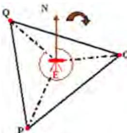
c) Se orienta el instrumento en la dirección del Norte y se tiene el cuidado de poner en  $0^{\circ}0'$  el instrumento (teodolito o tránsito).
