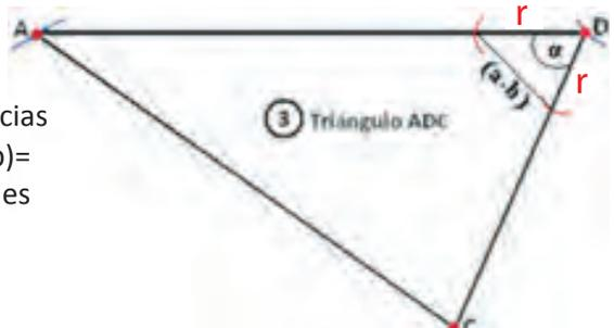
Para calcular el área se aplicará la fórmula general  $A = \frac{1}{2} a b \text{ sen} \alpha$ , la cual según nuestros datos quedará expresada como  $A_T (\text{ADC}) = \frac{1}{2} (A - D) (C - D) \text{ sen} \angle D$ , para ello se debe determinar primero el ángulo en **D** y la distancia **C-D**.
