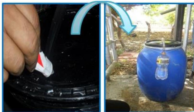
**Figura 7. Perforación, instalación del proceso anaeróbico y sellado del barril herméticamente**
