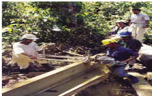
Foto 1 Aserrado utilizando motosierra con marco, Toncontín, Honduras.
