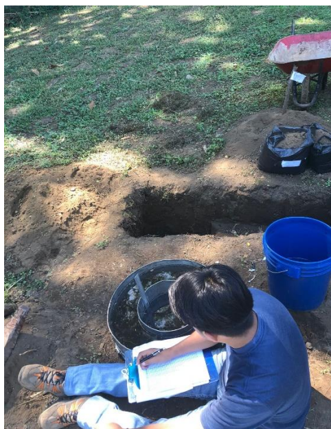
Anexo 8. Prueba de infiltración.
