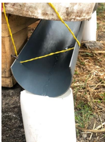
Anexo 14. Drenaje de los lisímetros
