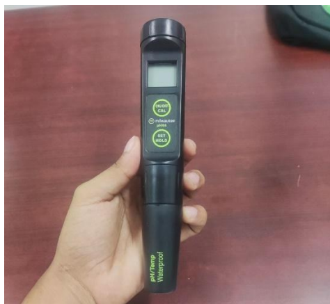
Peachímetro digital empleado para medir la acidez o alcalinidad.
