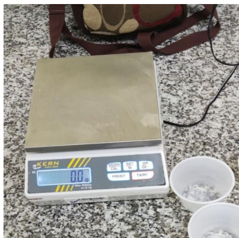
Balanza digital usada para medir el peso de las muestras.
