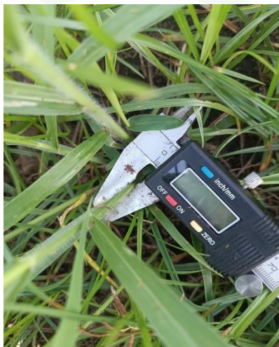
Anexo 12. Medición de diámetro del tallo (mm) de las plantas a los 30 días post siembra
