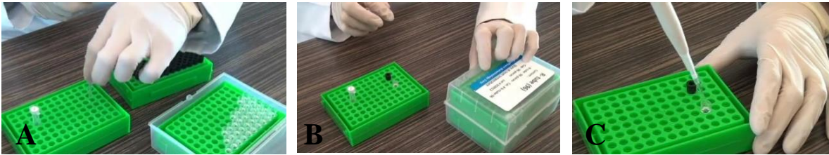
Figura 32 A, B y C. Se transfirió 50 \mu l de premezcla / mezcla de muestra al tubo R, se selló la parte superior de cada tubo R con una tapa y asegúrese de que el tubo R esté bien tapado Fuente: Divet, 2019
