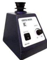
Figura 28. Agitador Vortex Mixer, 3150 rpm Fuente: Divet, 2019
