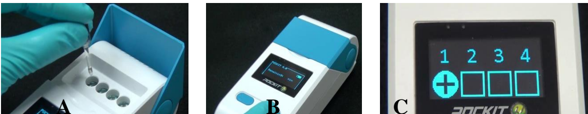
Figura 34 A, B y C. Se colocó el tubo R (control positivo) en el aparato (A), resultados cualitativos y iiPCR POCKIT plus (B y C) Fuente: Divet, 2019
