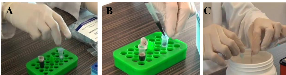
Figura 22 A, B y C. Se transfirió 600 \mu l de la mezcla a la columna(A y B), luego se giró a toda velocidad durante 1 minuto y desecho el flujo(C) Fuente: Divet, 2019
