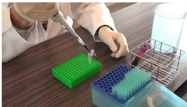
Figura 20. Se transfirió 200 \mu l de sangre fresca a un tubo de microcentrífuga de 1,5 ml, luego se agregó 600 \mu l de PB1 y mezcló bien durante 1 minuto Fuente: Divet, 2019
