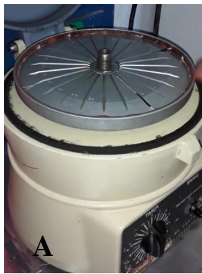
Figura 7 A y B. Extracción del tubo capilar de la microcentrifugadora (A) para la lectura del hematocrito en el lector comercial (B)
