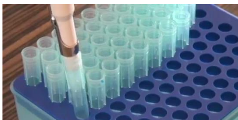
Figura 19. Se usó una nueva punta desechable al eje de la pipeta, se presionó lo suficiente para hacer un sello hermético
