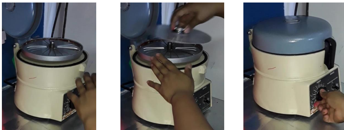
Figura 6. Se introdujo el tubo capilar en la microcentrífuga y se cerró el equipo programado a 10,000 rpm
