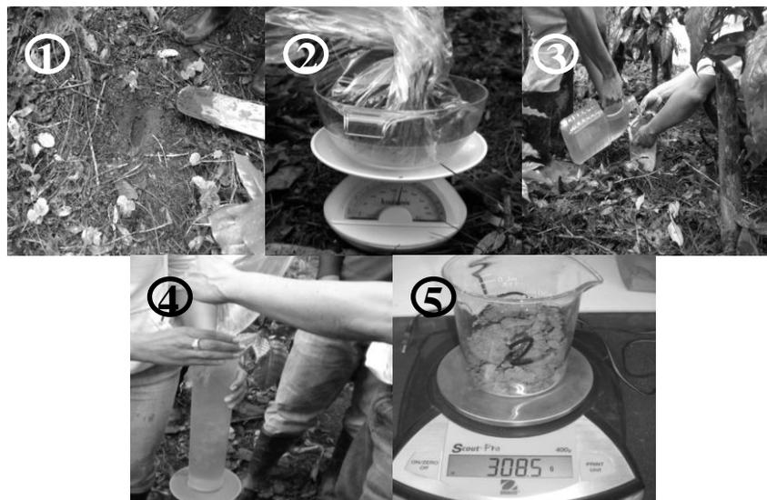
**Figura 7.** Determinación de la densidad aparente utilizando métodos de campo.
