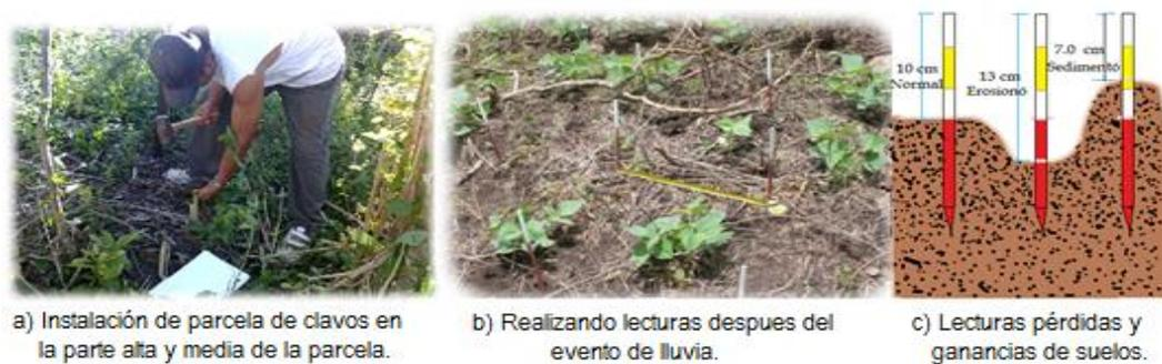
**Figura 3.** Instalación, monitoreo de la erosión y sedimentación de suelo (cm) a partir de las varillas de hierro con diferentes colores en las diferentes posiciones de las parcelas y la topografía.
