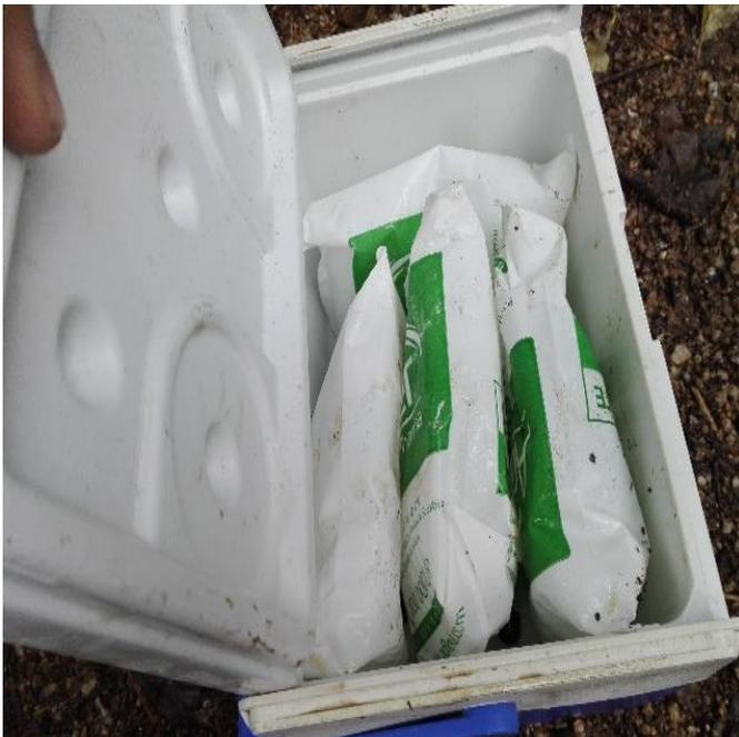
Figura 7. Termo con Gel refrigerante para trasladar las muestras
