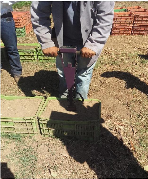
ANEXO 7: Muestreo de las concentraciones de humedad con el TDR (ensayo I).
