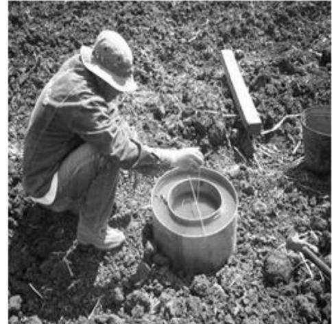
Foto 2. Toma de datos de lámina infiltrada con el método de doble anillo. (L. Cepeda)
