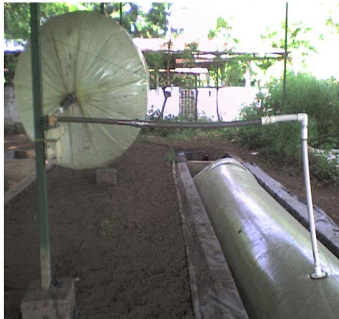
**l. reservorio instalado para la producción de biogás**
