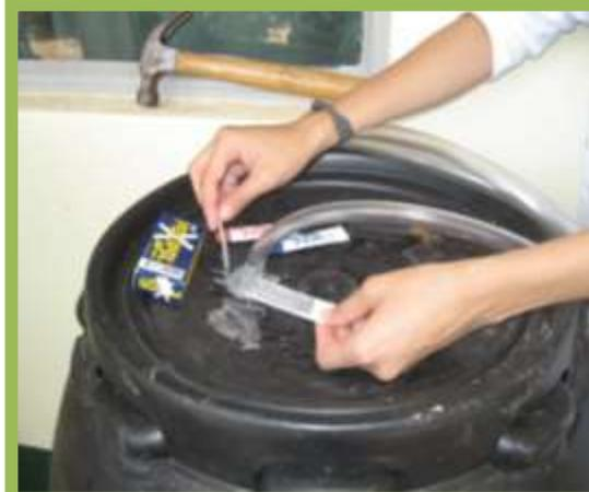
Figura 10. Perforación y sellado hermético en la tapa del barril.
